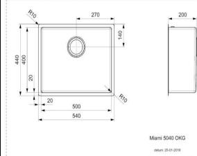
datum: 25-01-2018 Tolerantie buitenmaat per zijde: ±0.5mm Toleranz Aussenmasse pro Seite: ±0.5mm Per side the outside tolerance measure: ±0.
